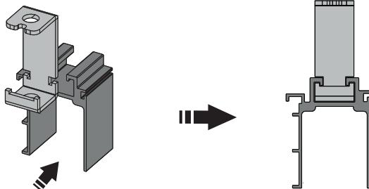
Pré distribuir as chapas conforme distâncias dos chumbadores para facilitar a montagem.
