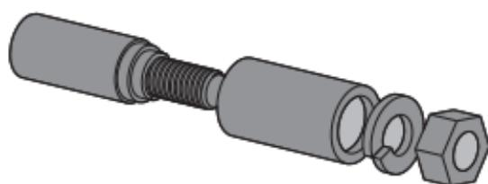
Encaixe o corpo com a capa no espaço indicado no carro interno (no lado do parafuso de regulagem) do SS 200, posicionando a parte rosqueada para dentro.
